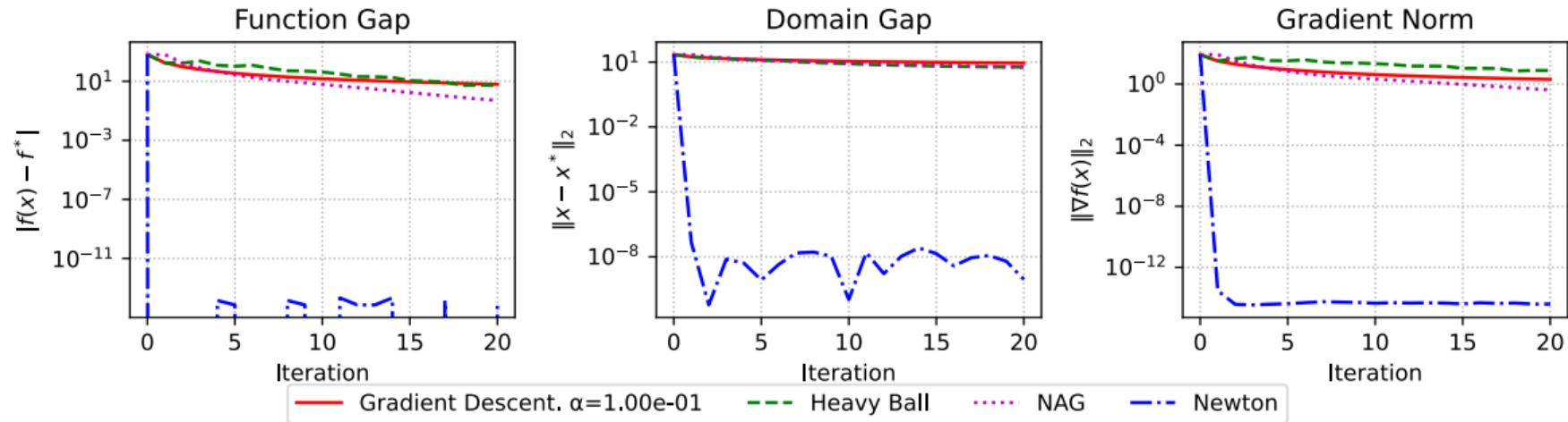
Рис. 4: В этом случае метод Ньютона тоже крайне быстро сходится, однако, отметим, что это происходит благодаря тому, что минимальное собственное число гессиана не 0, а около  $10^{-8}$ . Если применять метод Ньютона в наивной форме с обращением матрицы, то получится ошибка, так как матрица вырождена. На практике все равно можно использовать метод, если для направления итерации решать линейную систему  $\nabla^2 f(x_k) d_k = -\nabla f(x_k)$  методом наименьших квадратов.
