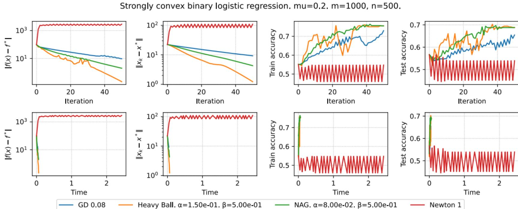
Рис. 8: Увеличим размерность в 50 раз и наблюдаем расходимость метода Ньютона. Это можно связать с тем, что мы инициализируем метод в точке, далекой от решения
