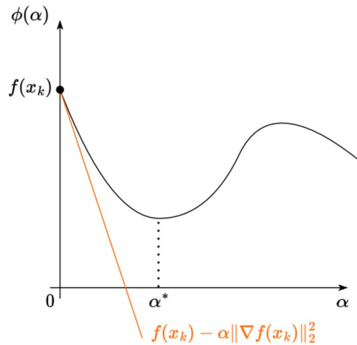
Рис. 15: Иллюстрация аппроксимации Тейлора  $\phi_0^I(\alpha)$
