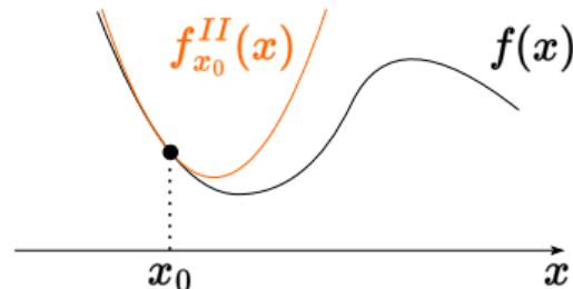
Рис. 2: Аппроксимация Тейлора второго порядка в окрестности точки  $x_0$
