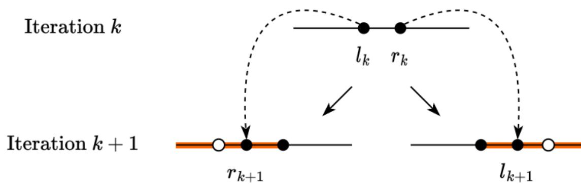
Рис. 14: Идея, позволяющая уменьшить количество вызовов функции
